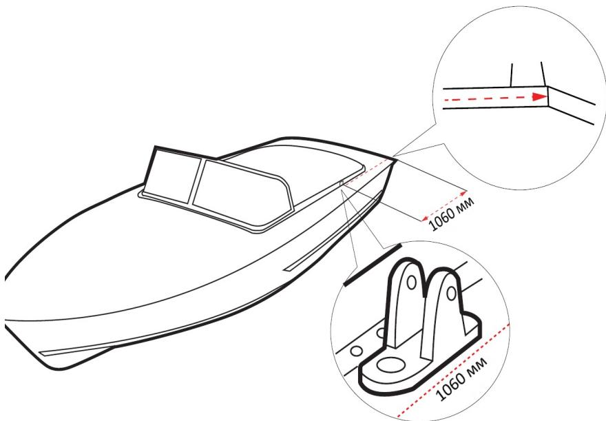
1. Установите кронштейн крепления дуг в Т-паз, на расстоянии 1060 мм (по центру кронштейна). Расстояние необходимо отмерять от места перелома планширя.
